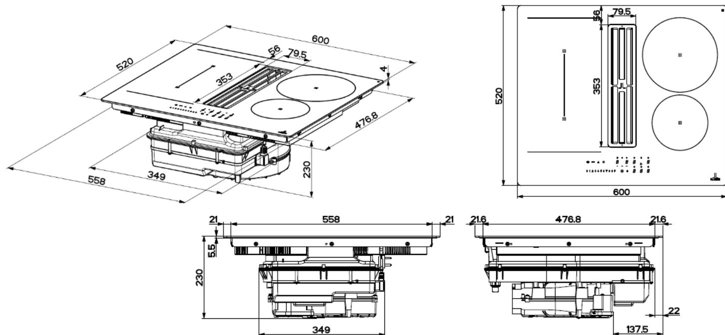
Diamètre de sortie : 220 x 90 mm (gaine plate)
